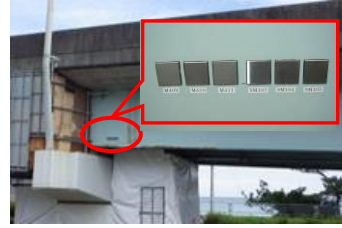
写真-8 坂下高架橋のワッペン式暴露試験片貼付け状況
