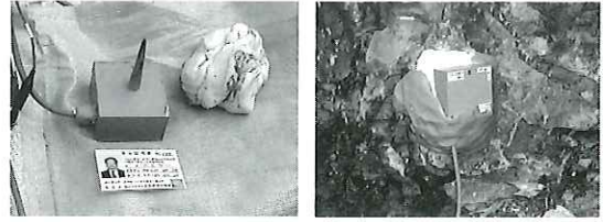
写真-1 振動計の事例（右は岩盤に設置した状況）
