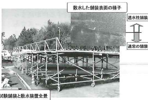
写真-2 実物大透水性舗装における散水試験
