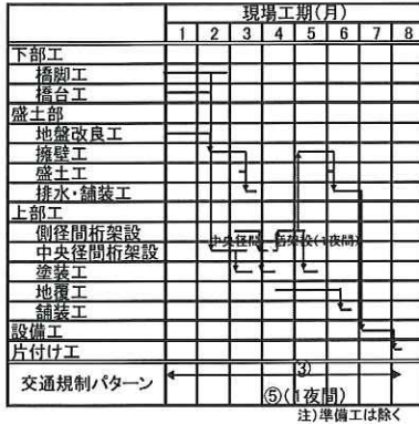
図-4 新工法による現場工程の例
