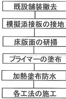
図-8 共通工の施工手順
