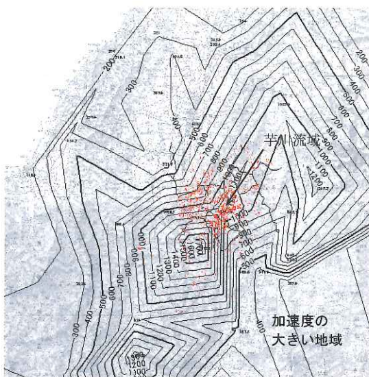
図-4 加速度分布(合成)と地すべり・崩壊の分布の関係
