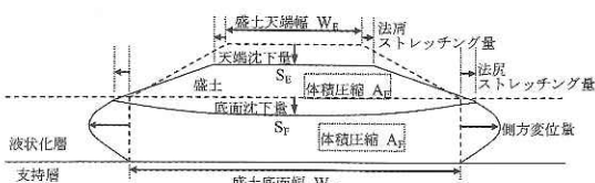
図-5 液状化地盤上の盛土の変形
