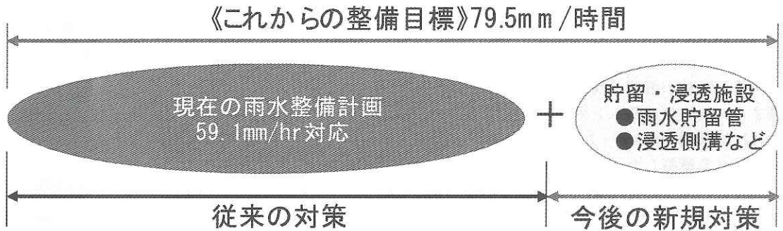
図-2 レインボープラン博多における降雨対策
