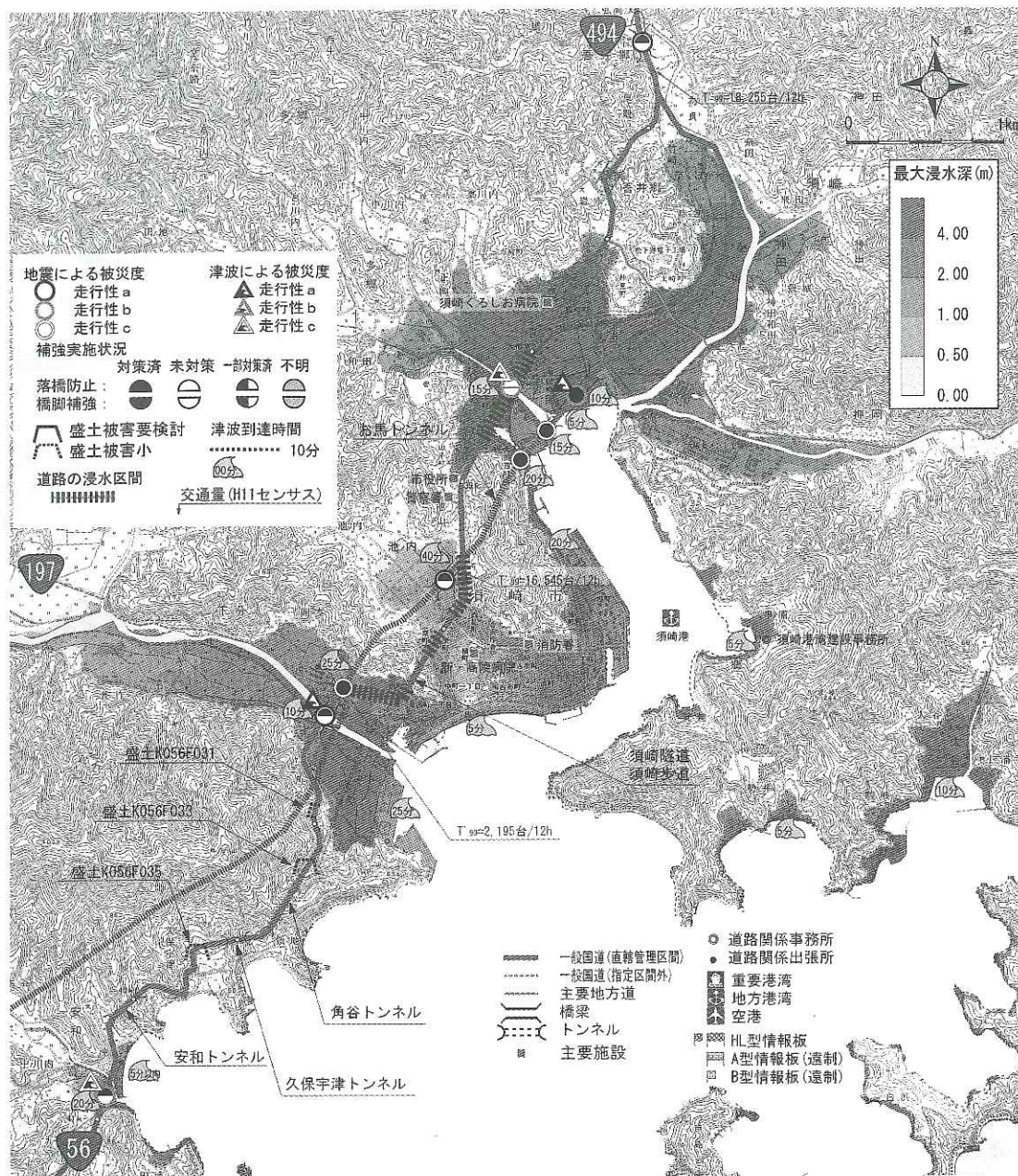
図-7 南海地震・津波による須崎市域の道路施設の被害想定マップ (試作版)
