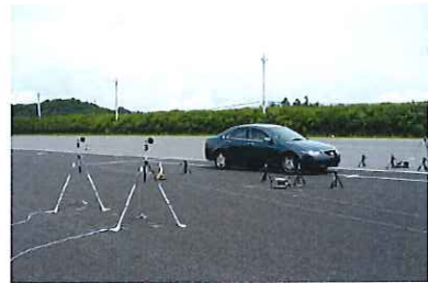
写真-2 試験走路上におけるパワーレベル測定例
