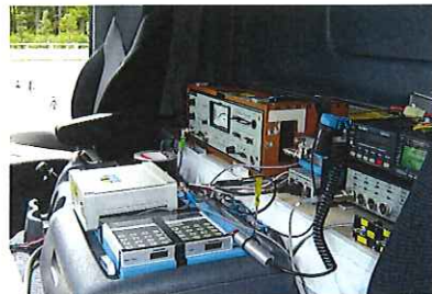
写真-3 市街地走行におけるエンジン回転数、速度、走行軌跡等の測定例
