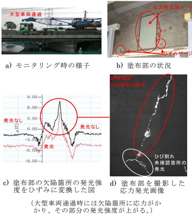
図-4 コンクリート橋ウェブに塗布したシートによるひび割れ箇所の発光の様子<sup>6)</sup>
