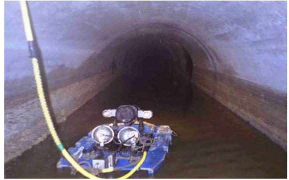
写真-4 大口径用テレビカメラ (船体型)
