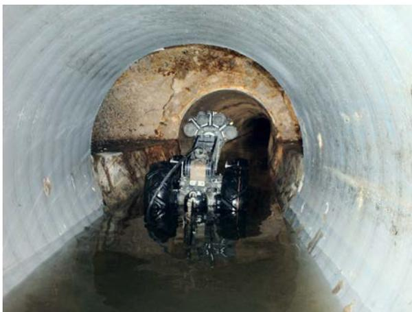
写真-3 大口径用テレビカメラ (車両型)
