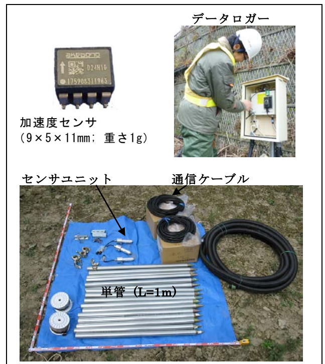
図-1 IT地盤傾斜計と付属器具類 (左上：加速度センサ（MEMSセンサ）；右上：データロガー；下：センサユニット・通信ケーブル・単管)
