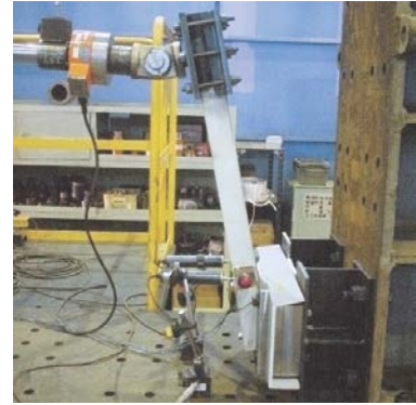
写真-5 支柱と歩廊桁の接合部の水平荷重試験
