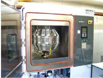
図-2 建設材料劣化シミュレーション実験装置
