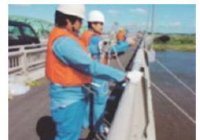
図-4 2人による橋上からのADCP搭載ボートの曳航
