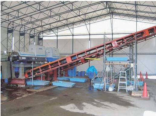
写真-6 仮設遠心脱水機 (南蒲生浄化センター)
