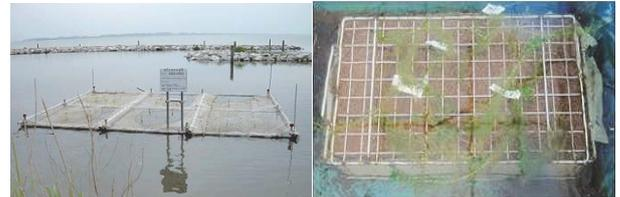
図-5 移植実験施設（左）と蛇籠(右)
