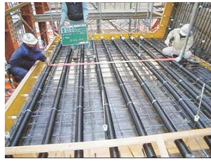
写真-3 実物試験体(底版)
