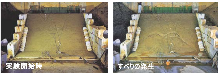
写真-3 すべりの発生状況 (Case5, F_c=50\% , D_c=90\% )
