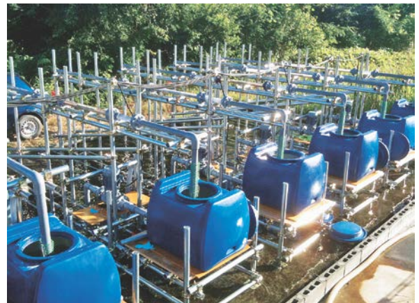
写真-2 実験に用いた循環型管路
