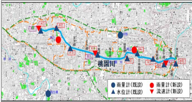
図-7 桃園川幹線の水門観測施設位置図 (図は東京都下水道局提供)
