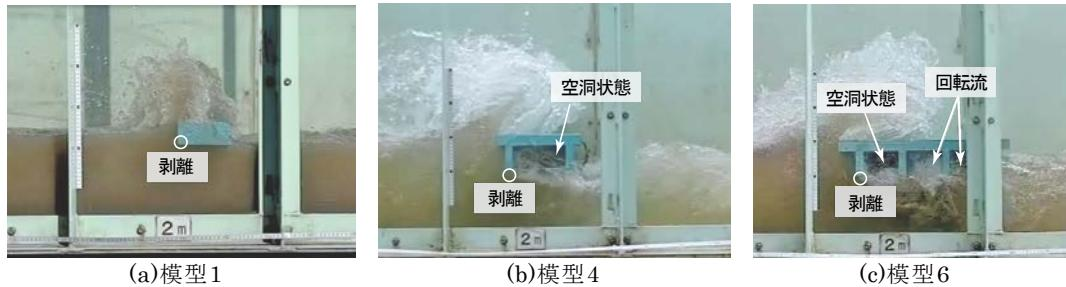
図-6 津波が橋梁模型に衝突する際の流況写真
