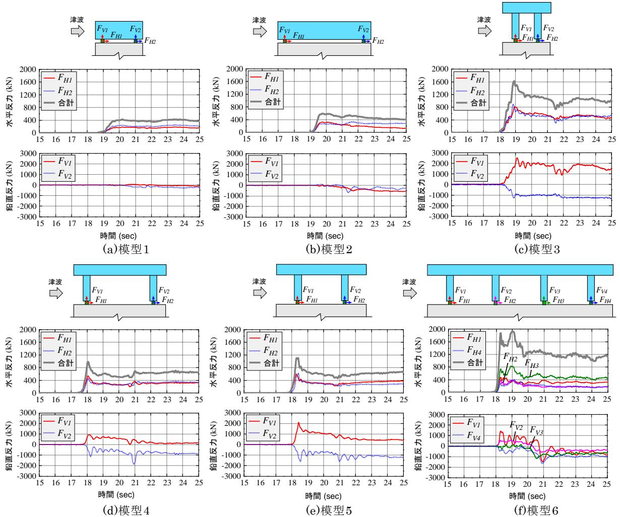
図-5 支承部反力の時刻歴挙動
