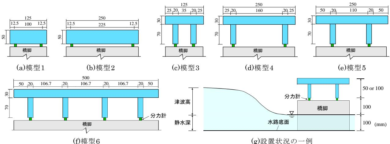
図-4 橋梁模型の断面詳細と設置状況
