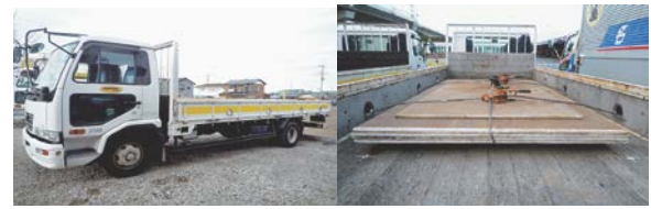
図-3 実験車両 (右図は敷鉄板4tを積載した状況)
