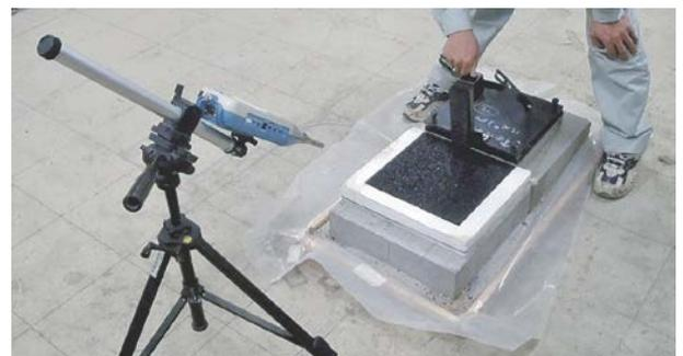
写真-1 ゴム板転倒試験状況
