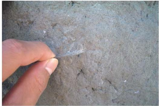
写真-4 施工表面と混入した高強度ポリエチレン (PE)繊維
