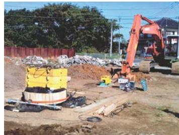
写真-4 実大摩擦特性確認試験
