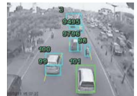
図-4 画像処理による交通量計測
