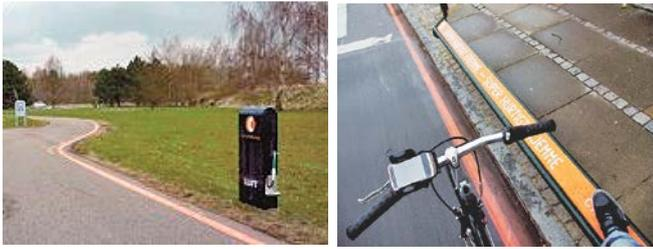
図-6 CSHsの状況<sup>9)</sup> (左：オレンジ色の路面表示及び空気入れ, 右：信号交差点付近の足置き)
