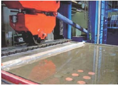
図-6 水張り・負曲げひび割れ発生状況でのSFRC舗装の輪荷重走行試験
