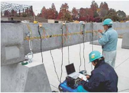
写真-1 模擬損傷部材への非破壊検査
