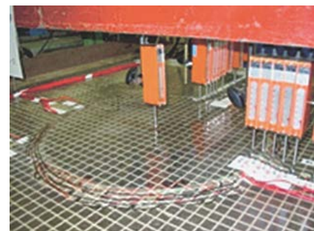
写真-2 大型の押抜き載荷試験時の状況
