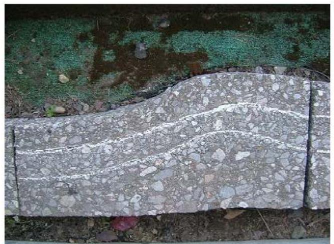
写真-3 表層に起因するわだち掘れ (左) と基層に起因するわだち掘れ (右)
