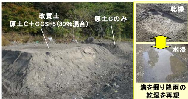
図-11 試験盛土の築造状況<sup>1)</sup>
