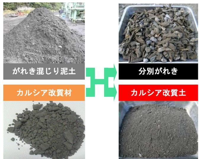
図-2 がれき混じり泥土の分別・改質結果の一例
