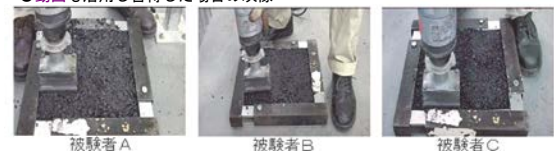
写真-2 映像素材の有効性検証 (ホイールトラッキング試験用供試体の作製)
