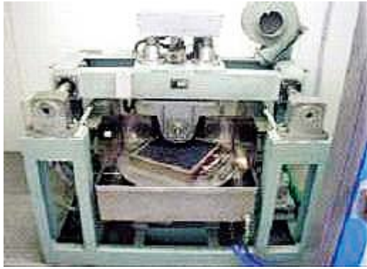
写真-1 骨材飛散抵抗性試験機の一例
