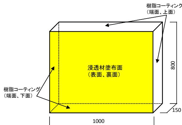
図-1 試験体の形状
