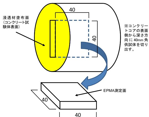
図-2 EPMA供試体のサンプリング
