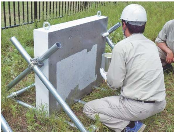
写真-2 浸透材塗布状況
