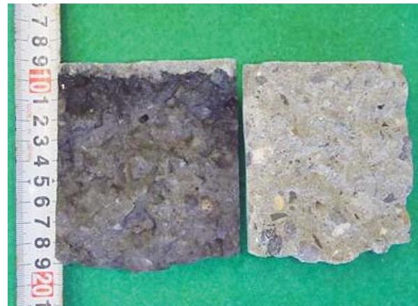
写真-3 浸透材浸透深さ測定の一例
