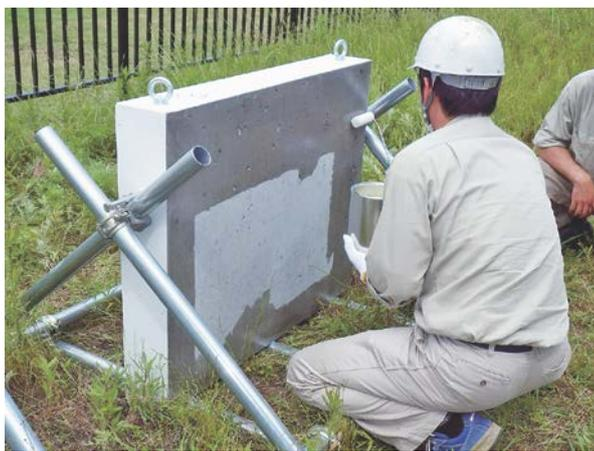
写真-2 浸透材塗布状況
