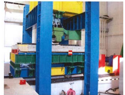
写真-4 輪荷重移動試験機(台車走行型)
