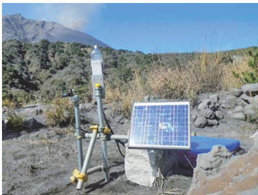
写真-4 自動降灰量計と技術試験衛星Ⅷ型を用いたデータ伝送実験
