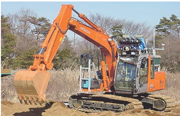
写真-1 開発した自律型バックホウ
