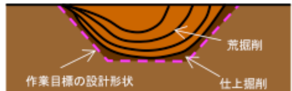
図-1 掘削動作のイメージ
