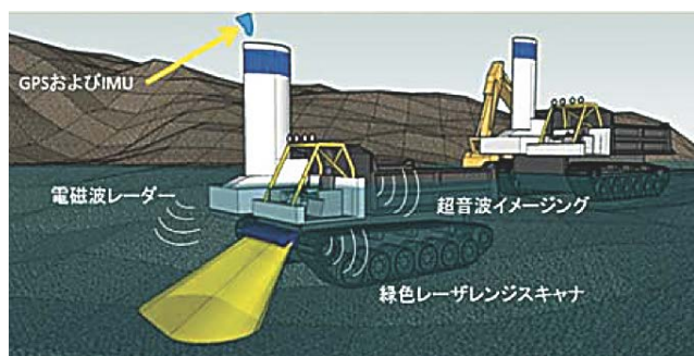
図-7 遠隔操作型半水中クローラードンプ(イメージ)
