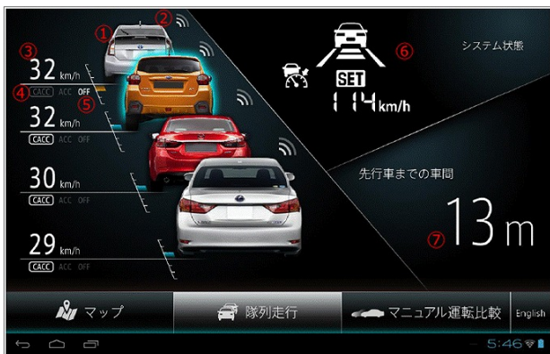
図-5 CACC作動中の隊列走行の通信状況画面
