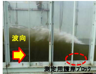
写真-3 護岸ブロックへの津波作用実験
