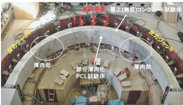
写真-1 覆工載荷試験状況
