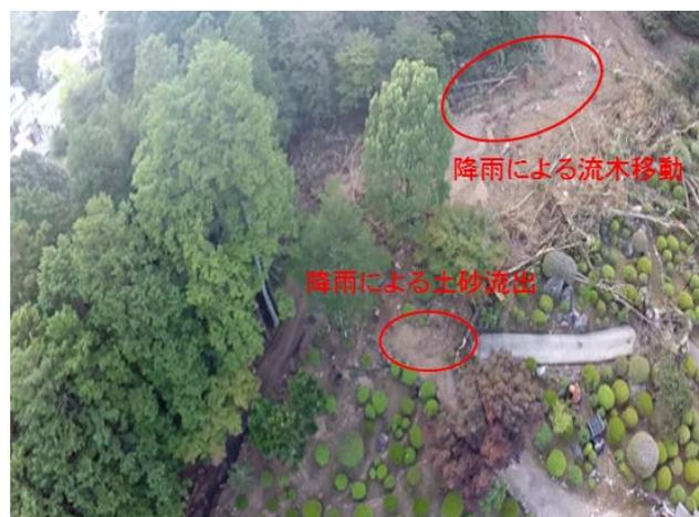
図-1 マルチコプターによる空撮映像（土砂流出状況）
