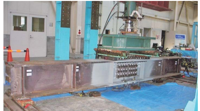
写真-4 桁曲げ試験の载荷状況
