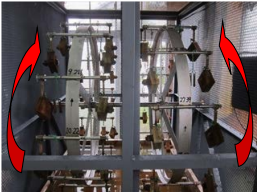
(a) 腐食促進試験状況
