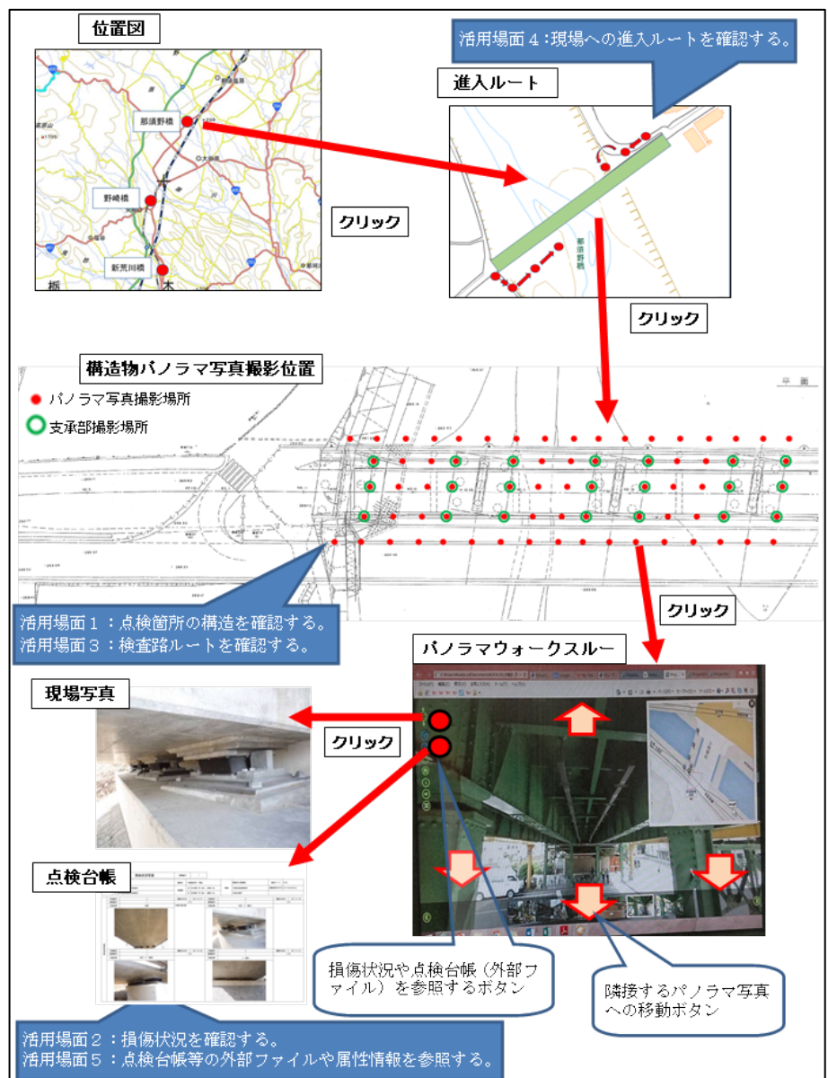
図-1 パノラマウォークスルーを用いた維持管理システムの全体構成
