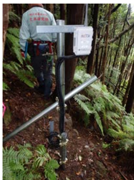
写真-5 那智川流域金山谷川に設置してある斜面崩壊検知センサー及び土壌水分計
