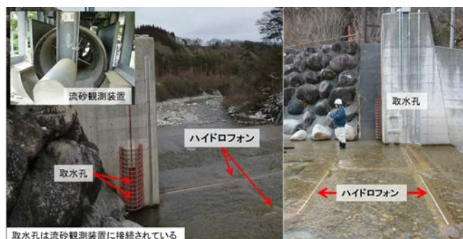
図-3 山地河道における流砂水文観測状況の例（天竜川水系与田切川流域坊主平砂防堰堤）
