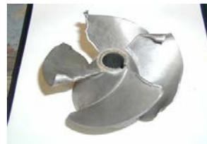
写真-13 変形したアルミの羽根
