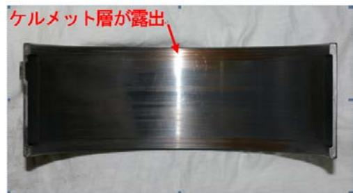
写真-4 H排水機場 クランクピンメタルの状況
