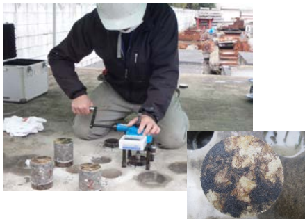
接合面の腐食状況
